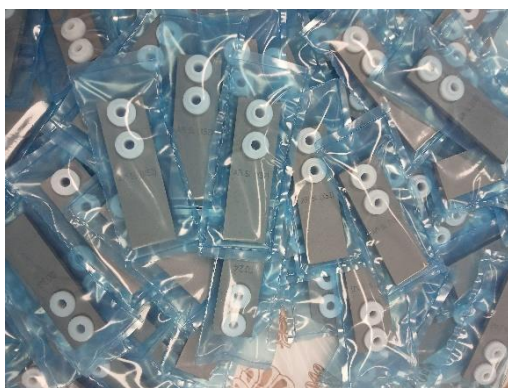
شکل ۴. تصویر کوپن‌های خوردگی (API 5L. X52N (PSL2)
