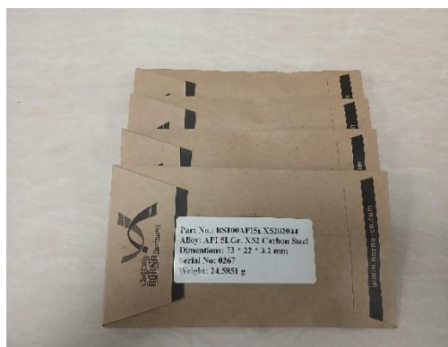
شکل ۴. تصویر کوپن‌های خوردگی (API 5L. X52N (PSL2)
